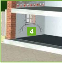
Bauteilrisse sind strukturelle Schwachpunkte. Sie verkürzen die Lebensdauer des gesamten Bauwerks, weil die Bausubstanz z.B. durch eindringendes Wasser merklich geschwächt wird. Ein elastischer oder kraftschlüssiger Rissverschluss ist erforderlich. Dazu wird mittels einer Druckinjektion über Injektionspacker der Rissverlauf mit einem Polyurethanharz verfüllt.
