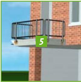
Schäden an Betonbauteilen, z. B. Ausbrüche, bedürfen der sofortigen Behandlung zur Wiederherstellung der ursprünglichen Eigenschaften. Freiliegende Bewehrungsstäbe müssen korrosionsschützend behandelt werden. Mit mineralischen Produkten wird die ursprüngliche Struktur wiederhergestellt.
