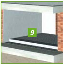
Nicht nur aus optischen Gründen ist es von Bedeutung, Böden von z. B. Garagen, Industriehallen oder Großküchen zu beschichten. Durch Schutzbeschichtungen werden diese Böden gegen mechanische Beschädigungen und gegen den Eintritt von Flüssigkeiten dauerhaft geschützt.
