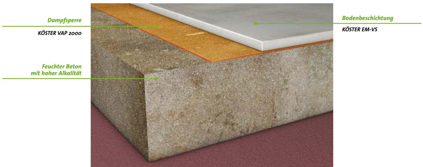
Betonböden mit rückwärtiger Durchfeuchtung können für nachfolgende Beschichtungen oder Bodenbeläge problematisch sein, da Feuchtigkeit und hohe Alkalität oft zu Ablösung von Beschichtungen führen können. In solchen Fällen muss eine Grundierung erfolgen, die eine sehr große Haftung aufweist, die eine sehr hohe Dampfsperrewirkung hat und gegen sehr hohe Alkalität beständig ist.
