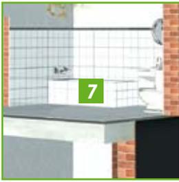
In diesen sensiblen Gebäudeteilen kann Feuchtigkeit zu erheblichen Schädigungen im gesamten Objekt führen. Verfärbungen und feuchte Stellen sind die ersten sichtbaren Folgen. Eine vollflächige Abdichtung solcher Räume führt zu einem dauerhaften Schutz. Dabei wird die Gesamtfläche im Wand- und Bodenbereich nahtlos abgedichtet. Die Abdichtung muss eventuelle Risse überbrücken können. Das gesamte KÖSTER BD System ist CE-geprüft und vom DIBt nach ETAG 022, Teil 1, zertifiziert.
