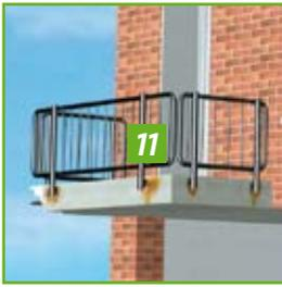
Für dieses Einsatzgebiet werden an die Abdichtung höchste Anforderungen gestellt. So muss sie witterungsbeständig und wasserdicht sein sowie eine gewisse statische Stabilität gewährleisten. Auch treten im Außenbereich erhöhte Bauwerksbewegungen auf, so dass es erforderlich ist, Abdichtungssysteme mit hoher Rissüberbrückung einzusetzen.
