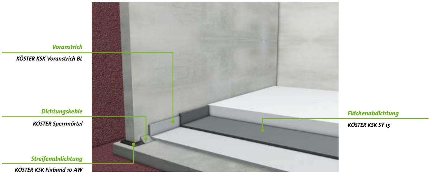
*Schnell, einfach und ohne lange Wartezeiten: Die Abdichtung der Bodenplatte mit KÖSTER KSK-Dichtungsbahnen.*
