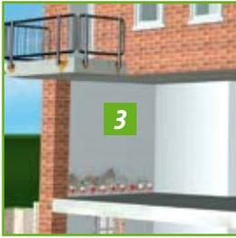
Aufsteigende Feuchtigkeit in Mauerwerken führt auf Dauer zu erheblichen Schäden. Anzeichen sind Salzausblühungen, abplatzender Putz, moderrnde Tapeten und die Bildung gesundheitsschädlicher Schimmelpilze. Anhand eines patentierten Verfahrens wird ein unverrottbares und dauerhaft elastisches Kunstharz drucklos in das Mauerwerk eingebracht, so dass eine nachträgliche Horizontalabdichtung gegeben ist und keine Feuchtigkeit mehr kapillar aufsteigen kann.
